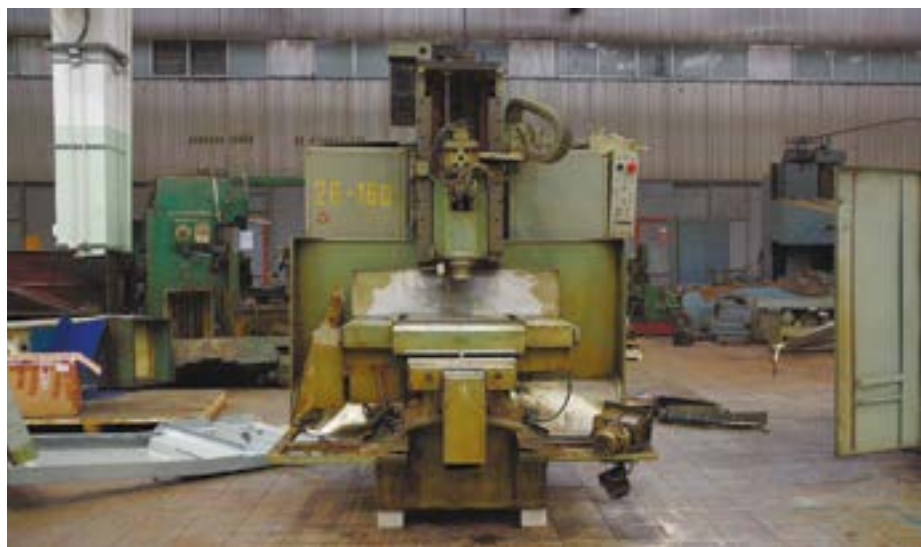
3-х координатный фрезерный станок модели VM-12-500 до выполнения ремонта на участке модернизации оборудования станкостроительного производства ПАО «КАДВИ».
