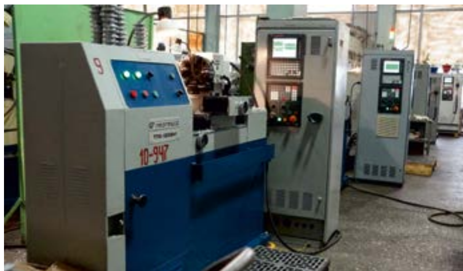
Линейка модернизированных токарных станков модели ТПК-125 с системой ЧПУ NC-301
