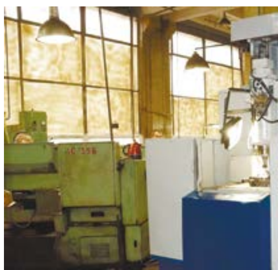
3-х координатный фрезерный ЧПУ NC-230 в цехе точной механики
