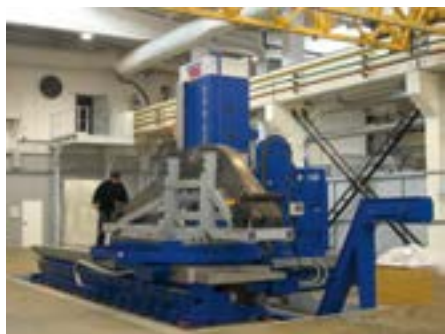
Двустороннее фрезерование стрелы экскаватора
