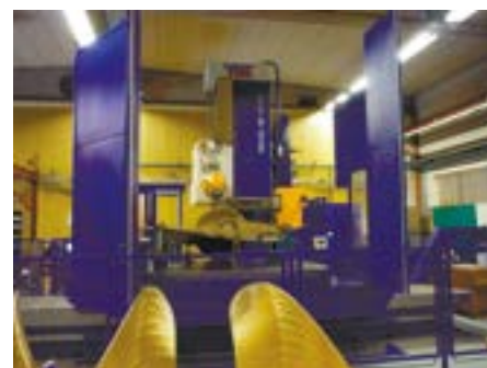
Обработка лопасти корабельного винта
